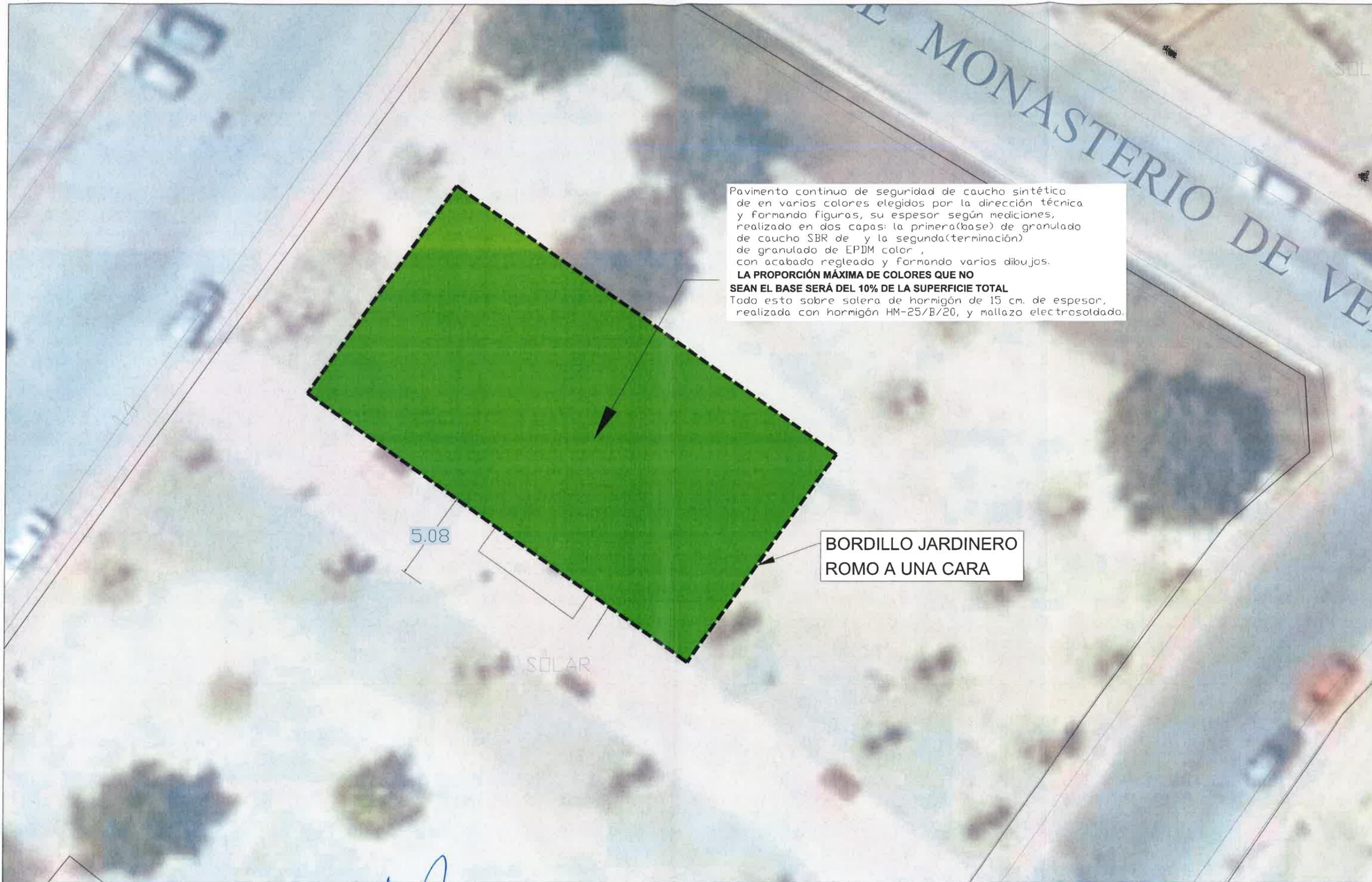
Pavimento continuo de seguridad de caucho sintético de en varios colores elegidos por la dirección técnica y formando figuras, su espesor según mediciones, realizado en dos capas: la primera(base) de granulado de caucho SBR de y la segunda(terminación) de granulado de EPDM color , con acabado regleado y formando varios dibujos.
