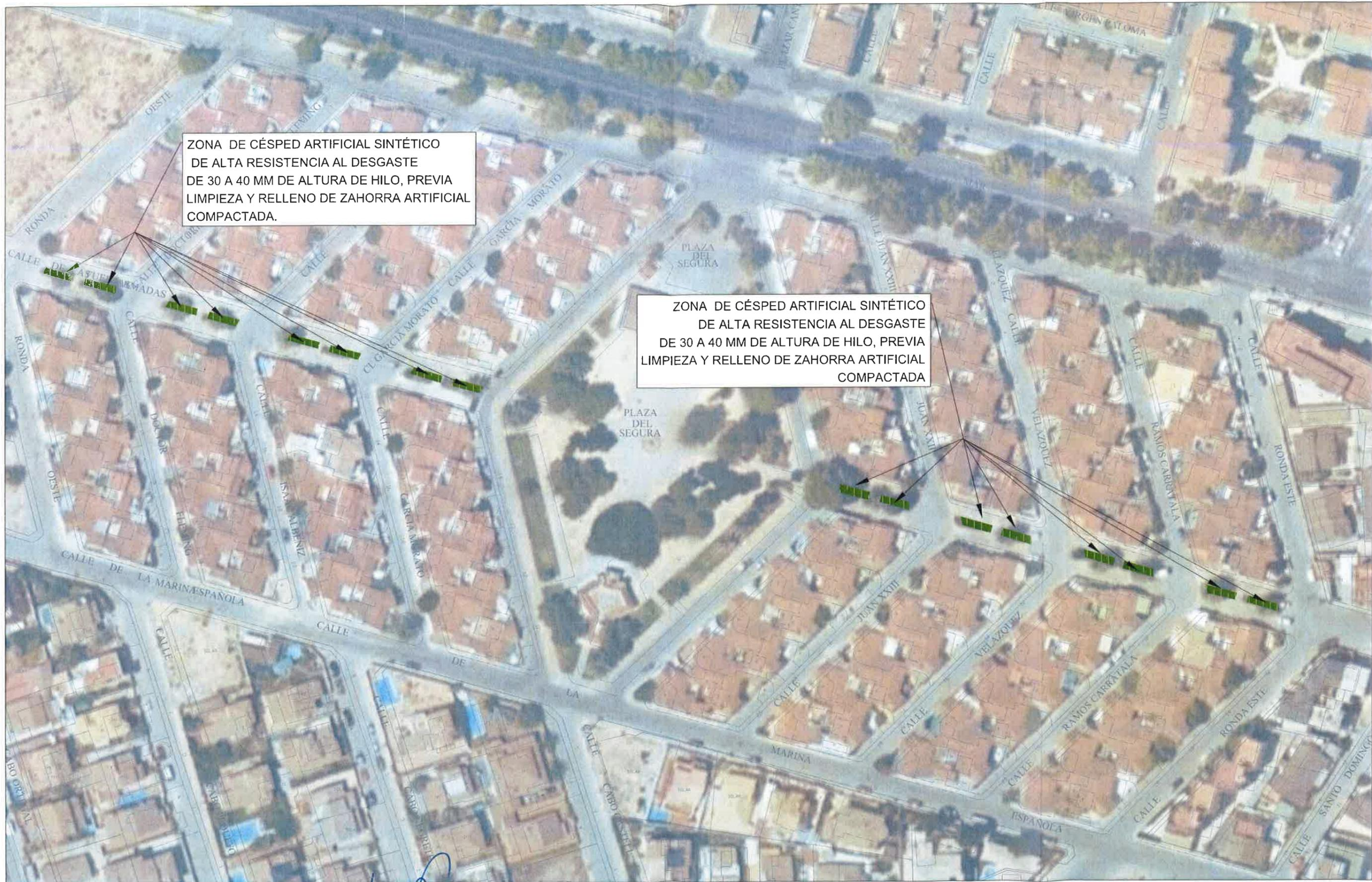
ZONA DE CÉSPED ARTIFICIAL SINTÉTICO DE ALTA RESISTENCIA AL DESGASTE DE 30 A 40 MM DE ALTURA DE HILO, PREVIA LIMPIEZA Y RELLENO DE ZAHORRA ARTIFICIAL COMPACTADA.
