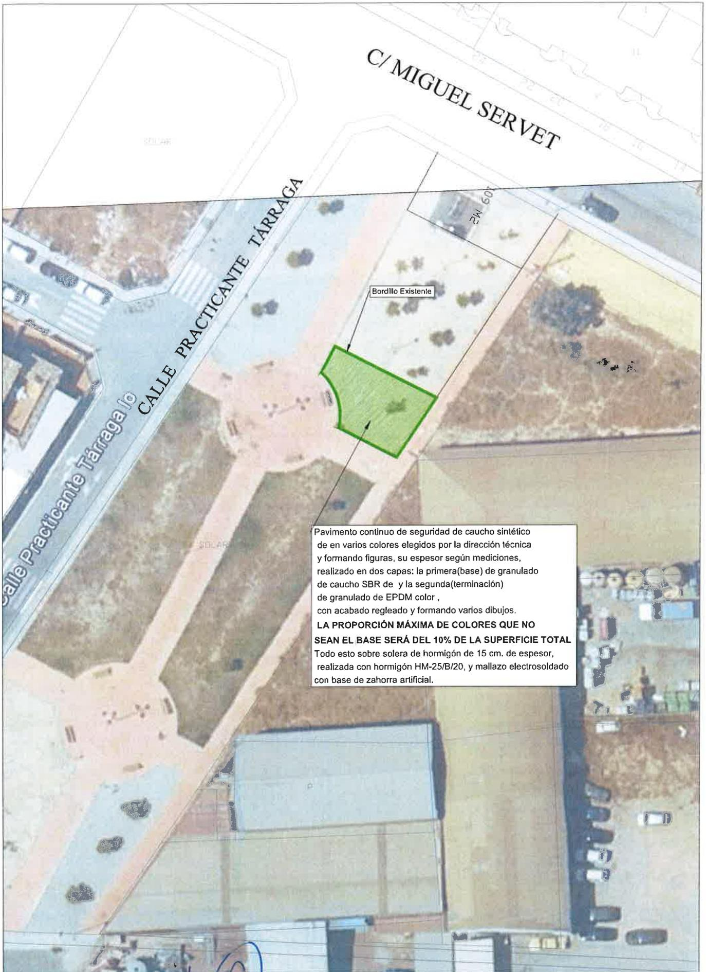
Pavimento continuo de seguridad de caucho sintético de en varios colores elegidos por la dirección técnica y formando figuras, su espesor según mediciones, realizado en dos capas: la primera(base) de granulado de caucho SBR de y la segunda(terminación) de granulado de EPDM color , con acabado regleado y formando varios dibujos.
