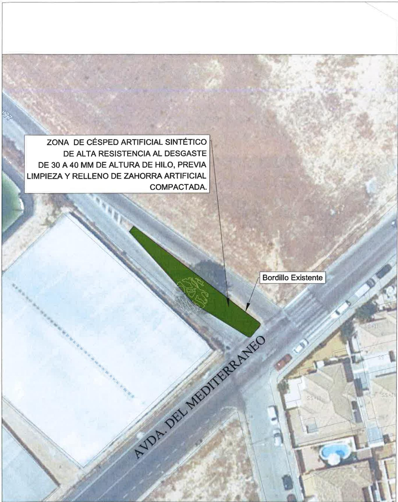
ZONA DE CÉSPED ARTIFICIAL SINTÉTICO DE ALTA RESISTENCIA AL DESGASTE DE 30 A 40 MM DE ALTURA DE HILO, PREVIA LIMPIEZA Y RELLENO DE ZAHORRA ARTIFICIAL COMPACTADA.
